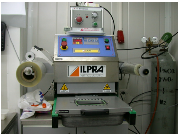
Foto 5: macchina termosaldatrice usata per il confezionamento dei frutti di ficodindia sbucciati
