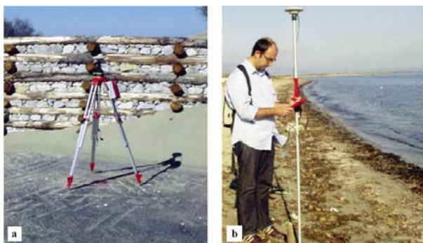
Figura 5 - Ricevitori GPS a doppia frequenza (reference a sinistra e rover a destra) [da CARLI et al., 2004].
