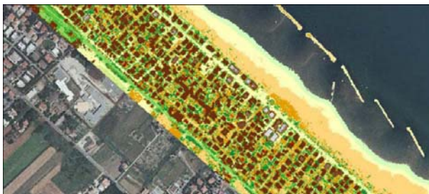
Figura 8 - Scansione di un tratto di fascia costiera con tecnica LIDAR [da PERINI et al., 2006]
