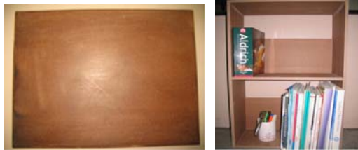
Fig 2, a-b: Esempi di prodotti realizzati con compositi legno-plastica: pannello (a), scaffali (b)
